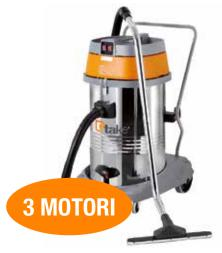
WETTY 803 B: Aspiratore solidi-liquidi carrellato, di grandi prestazioni, dotato di serbatoio in acciaio inox e kit antistatico, ha la possibilità di utilizzare accessori da Ø 40 per portate elevate, possibilità di utilizzare un singolo motore, due o tre contemporaneamente, involucro con capacità di basculamento e con gancio di bloccaggio; capacità serbatoio 80 lt; potenza max 3450 W; portata aria 150 lt/s; 3 motori; peso 26 kq; dimensioni 610 x 520 x 920 mm.
