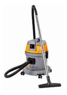
WETTY 221: Aspiratore solidi-liquidi capacità serbatoio 22 It; potenza max 1150 W; portata aria 53 It/s; 1 motore; peso 8,8 kg.; dimensioni 410 x 410 x 560 mm, filtro cartuccia HEPA opzionale, sacchetto carta opzionale.
