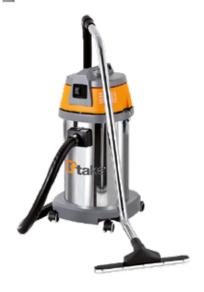
WETTY 351: Aspiratore solidi-liquidi caratterizzato da robusto serbatoio in acciaio inox e dotato di kit antistatico, filtro tela in dotazione, filtro cartuccia HEPA opzionale; capacità serbatoio 36 lt; potenza max 1150 W; portata aria 53 lt/s; 1 motore; peso 10,4 kg; dimensioni 410 x 410 x 760 mm.
