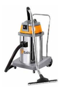
WETTY 501: Aspiratore solidi-liquidi carrellato, di buona capienza e grande potenza, dotato di kit antistatico e serbatoio in acciaio inox, filtro tela in dotazione; capacità serbatoio 50 lt; potenza max 1350 W; portata aria 58 lt/s; 1 motore; peso 14 kg; dimensioni 500 x 500 x 840 mm.
